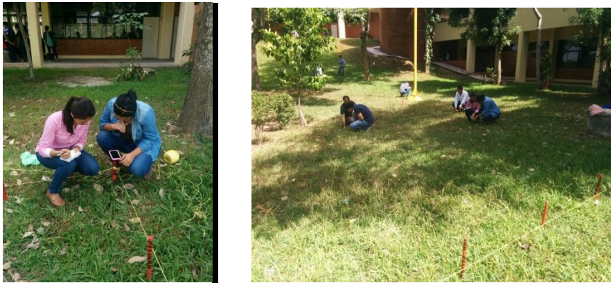
Figura 4.- Estas imágenes presentan como los alumnos usan sus dispositivos electrónicos como magnetómetros, midiendo las componentes del campo magnético y asociándolo a las coordenadas dispuestas previamente sobre el terreno. Los alumnos registran en una libreta de transito las coordenadas del punto y la lectura del Ipad, esto representa un sistema coordenado “x”, “y” y “z”.
